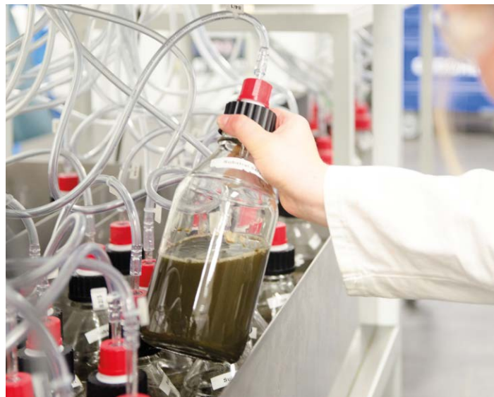
Afbeelding 2: Testinstallatie voor het onderzoek van het gaspotentieel met behulp van batchgistingstests
