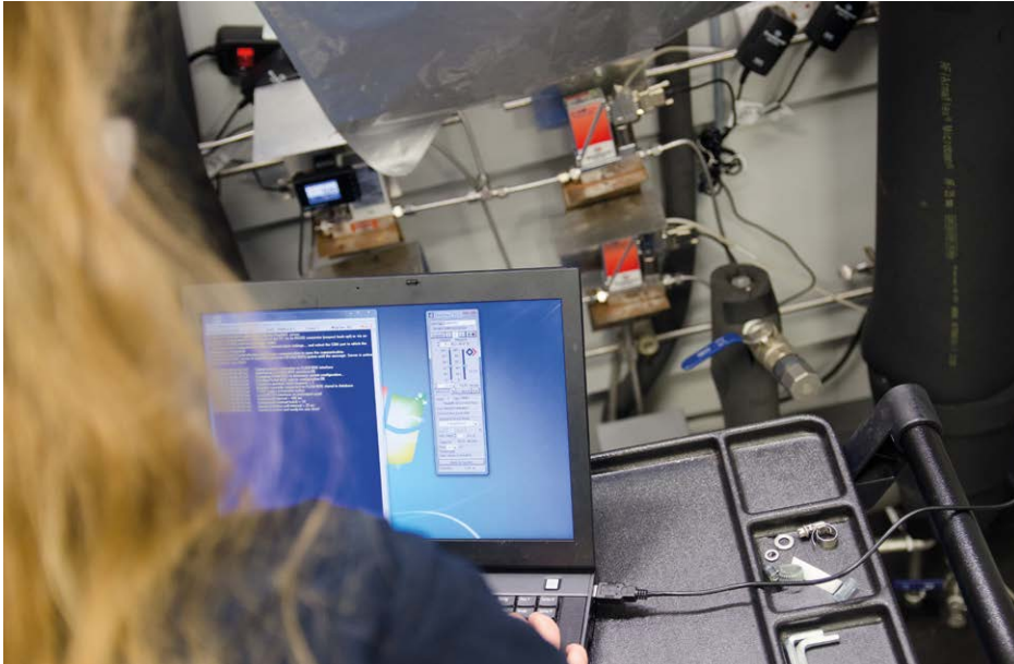
Afbeelding 3: De feed wordt geregeld via de doorstroomregelaars
